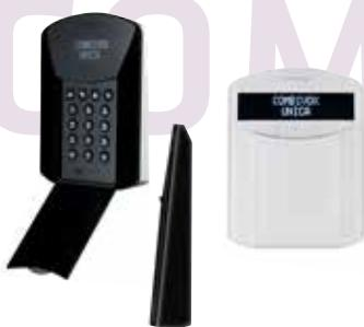
Tastiera LCD + LED su BUS RS485 compatibile con **tutte le centrali Combivox**. Display LCD a 2 righe per menu facilitato; 3 led di segnalazione; microfono-altoparlante per menu vocale; 1 zona di allarme (NC, NA, SING. BIL.) on board e lettore di prossimità integrato per le funzioni di inserimento/disinserimento e l'attivazione di scenari. Dotata di staffa con circuito ad innesto per il collegamento al BUS per una installazione rapida e facile. Dimensioni (L x H x P in mm): 120 x 155 x 30.
