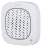
Sirena wireless intercom da interno, microfono integrato, indicatore luminoso, 1 tasto accensione, 1 tasto antipanico, buzzer, allarme antimanomissione, update remoto tramite cloud, segnalazione batteria scarica, frequenza portante 868~868.6 MHz, comunicazione bidirezionale, crittografia AES128, salto di frequenza, 4 batterie CR123A (durata 3 anni)/12 Vdc
