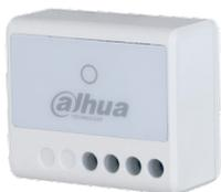
Switch a parete wireless da interno con 1 output relè (NO/NC 100-240 Vac, max. 13A), 1 indicatore luminoso, 1 tasto, update remoto tramite cloud, modalità test, frequenza portante 868~868.6 MHz, comunicazione bidirezionale, salto di frequenza, crittografia AES128, alimentazione 100~240 Vac
