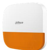
Sirena wireless da esterno IP65 da 110 dB, indicatore luminoso, 1 tasto accensione, 1 buzzer, allarme antimanomissione, update remoto tramite cloud, potenza segnale, segnalazione batteria scarica, frequenza portante 868~868.6 MHz, comunicazione bidirezionale, crittografia AES128, salto di frequenza, 4 batterie CR123A (durata 3.4 anni)/12 Vdc
