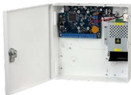
Centrale antintrusione filare integrabile e modulare con 8 aree a bordo + 8 zone espandibili, 1 porta LAN 10/100 Mbps, 2 porte RS485 per collegamento moduli aggiuntivi e tastiere
