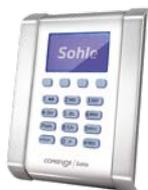
Tastiera in policarbonato verniciato e profili in alluminio su BUS RS485 compatibile con **tutte le centrali Combivox**. Display LCD grafico. 4 tasti menù multifunzione per inserimento/disinserimento, esclusione zone, gong, scenari, etc.; microfono e altoparlante per guida utente a sintesi vocale. 1 zona di allarme (NC, NA, SING. BIL.). Sonda di temperatura. Interfaccia utente ad icone. Funzione di campanello vocale delle zone. Dimensioni (L x H x P in mm): 102 x 156 x 24.
