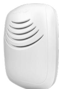
Sirena piezoelettrica su BUS RS485 da interno autoalimentabile con batteria per segnalazione di taglio fili. Funzionamento su BUS anche senza batteria. 8 differenti toni selezionabili. Struttura in ABS bianco. Batteria non inclusa. Resa sonora max 100 dB (A) a 1 m. *Disponibile anche in versione Stand-Alone (no BUS).* Dimensioni (L x H x P in mm): 109 x 150 x 54.
