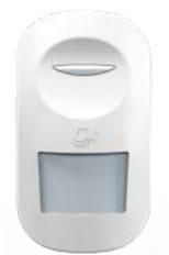
Rivelatore volumetrico DT (IR+MW) su BUS RS485 per centrali Combivox. destinato ad un uso professionale e civile. Area di copertura massima 12m per 90°. Antimask attivo su IR per accecamento a contatto su lente. Esclusione MW ad impianto disinserito (GREEN ACTIVE).
