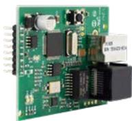
Modulo IP LAN plug & play per montaggio su scheda centrale compatibile con centrali linea Amica e Wilma. Programmazione tecnica via software CombiTEC in LAN e tramite INTERNET; gestione utente delle funzioni della centrale tramite web browser e **APP Simplya Cloud** (Android e iOS).
