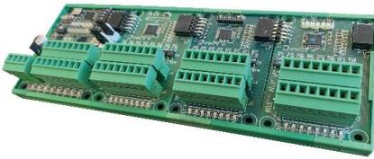
IB-SYSTEM LITE è un nuovo sistema compatto e modulare per la raccolta allarmi di tutti i sensori digitali (MANTA, MURENA, CORAL PLUS, ERMO482XPRO 3.0, MICRO-RAY, SIOUX PRO2) di facile espandibilità, è semplice da configurare e raccoglie lo status fino a 40 sensori via RS485 o IP. IB-SYSTEM LITE è ideale per piccoli impianti, ottimizza i cablaggi, cost-saving rispetto a sistemi di cablaggio tradizionali su moduli di espansione distribuiti.
